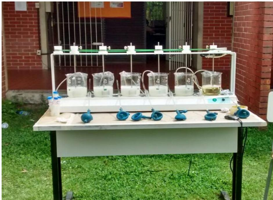
**Figura 11.** Experimento de fotocatalise com o efluente do biodiesel
