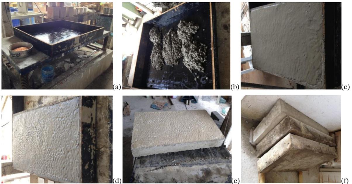
**Figura 30.** Fotos do processo: Concretagem de paredes para ensaios na câmara térmica.
