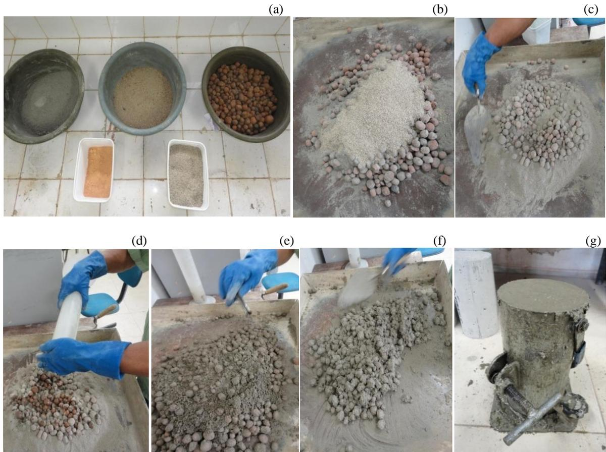
**Figura 22.** Fotos do processo de preparo do traço e moldagem dos corpos de prova.
