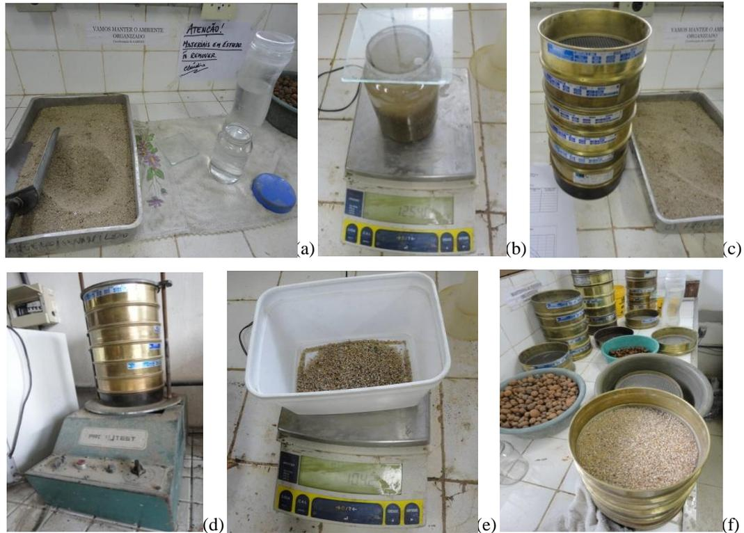
**Figura 20.** Fotos do processo de caracterização do agregado miúdo.
