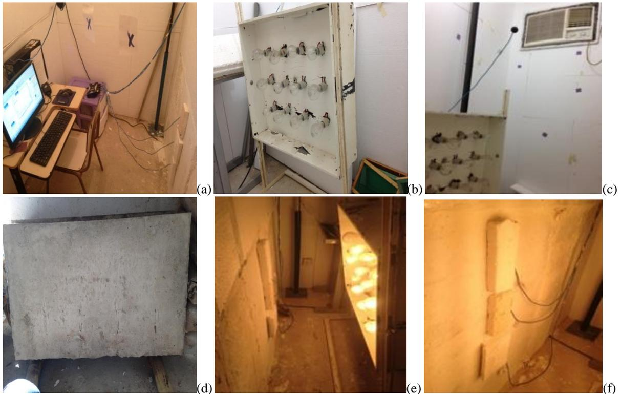
**Figura 35.** Câmara Térmica do LABEME com (a) Sist de aquisição de dados, (b) Caixa de lâmpadas, (c) Ar-condicionado e globo negro, (d) Parede protótipo, (e) Aquecimento, (f) Conexão de termopares.
