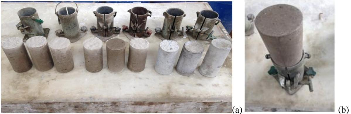
**Figura 23.**Fotos do processo de desmolde dos corpos de prova.
