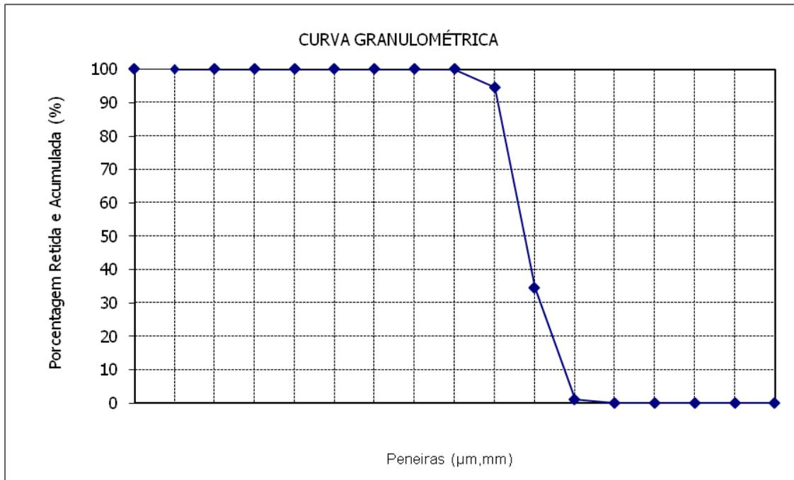
**Figura 39.** Curva granulométrica do Agregado Graúdo.
