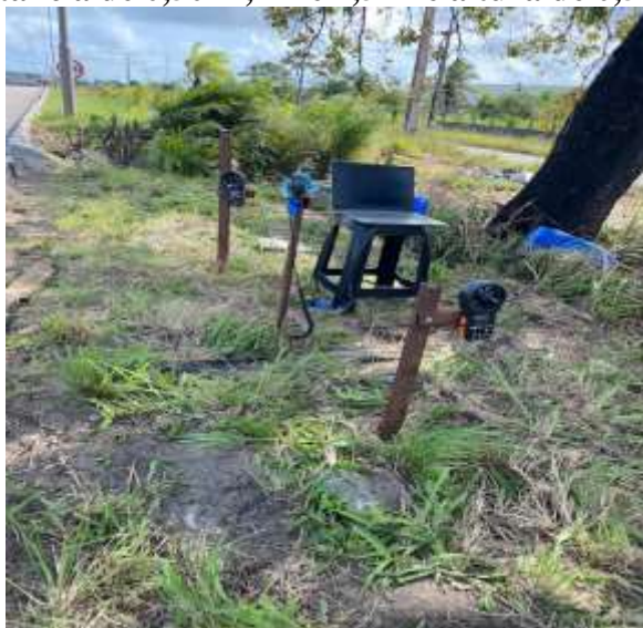
Figura 44. Aparato experimental da terceira coleta de dados. Ângulo de 0°, 45° e 90°, distância de 0,50 m, 1m e 1,5 m e altura de 0,50 m.
