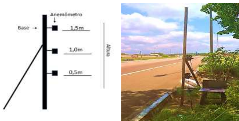
Figura 41. Aparato experimental da primeira coleta de dados. Ângulo de 0°, 45° e 90°, distância de 0,50 m, 1m e 1,5 m e altura de 0,50 m, 1 m, 1,5 m.
