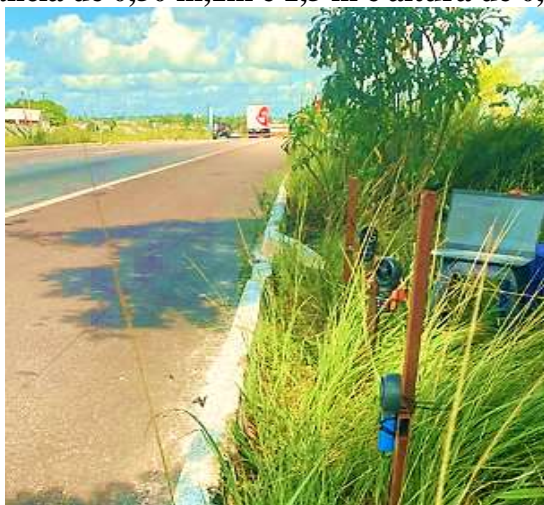
Figura 43. Aparato experimental da segunda coleta de dados. Ângulo de 0°, 45° e 90°, distância de 0,50 m, 1m e 1,5 m e altura de 0,50 m.
