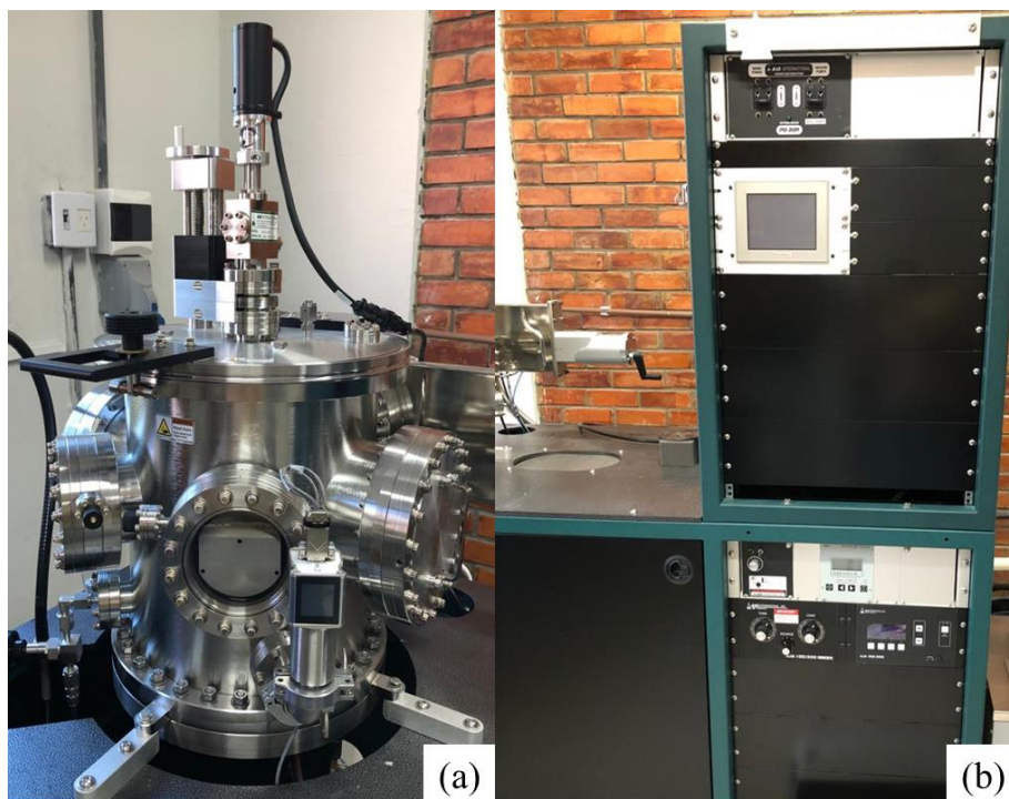
Figura 26 – Sistema de deposição Sputtering . (a) Câmara de deposição e (b) sistema de controle.
