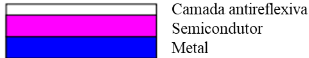
Figura 10 – Superfície seletiva do tipo absorvedor sobreposto sobre metal. Fonte: Adaptado de Kennedy (2002).
