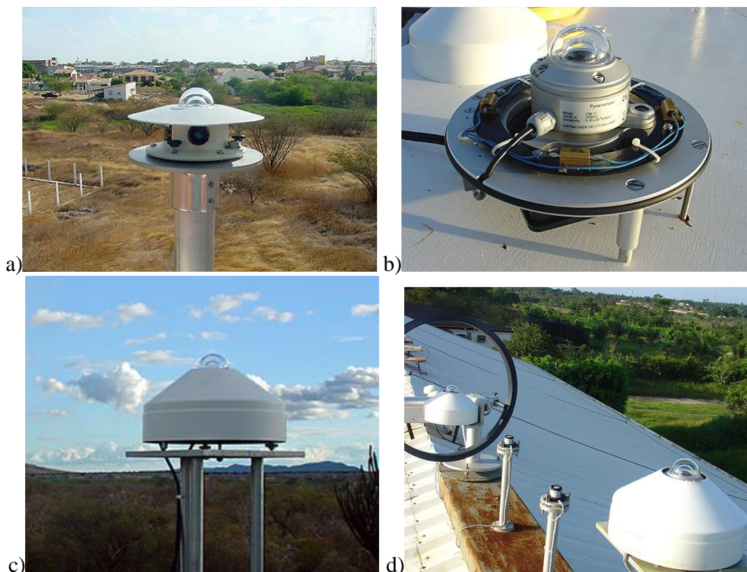
Figura 3.2. Piranômetros das estações: a) Caicó, b) Natal, c) Petrolina e d) São Luís
