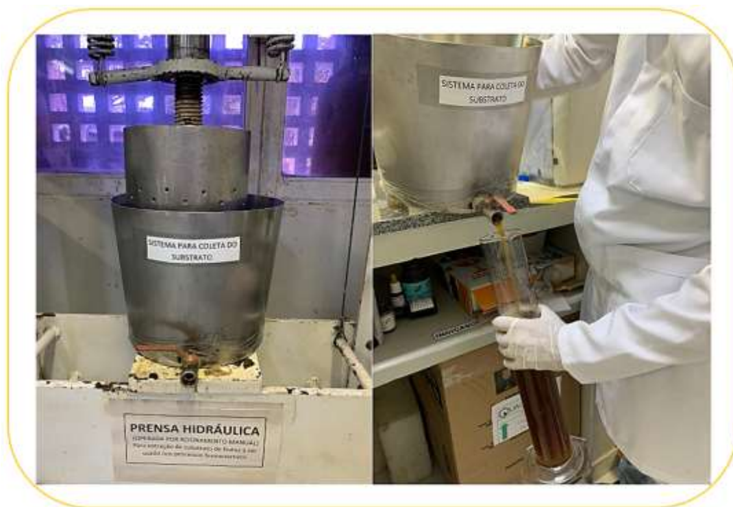
Figura 17. Sistema para a coleta do substrato das vagens prensadas da algarobeira.
