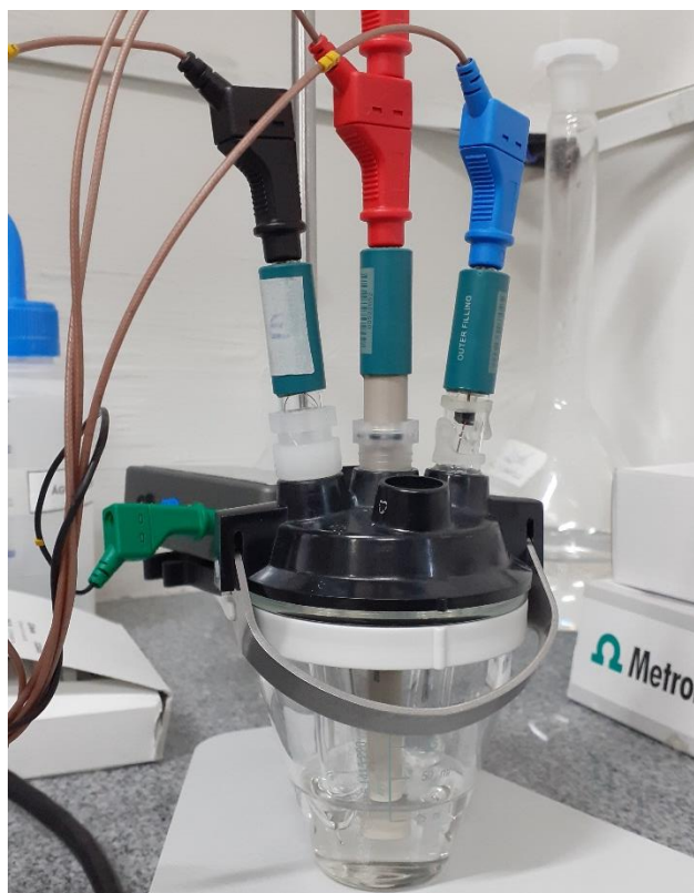
Figura 8: Representação da célula eletroquímica composta por eletrodo auxiliar de platina (preto), eletrodo de trabalho de carbono vítreo (vermelho) e eletrodo de referência Ag/AgCl (azul). Imagens registradas pela autora (2022).
