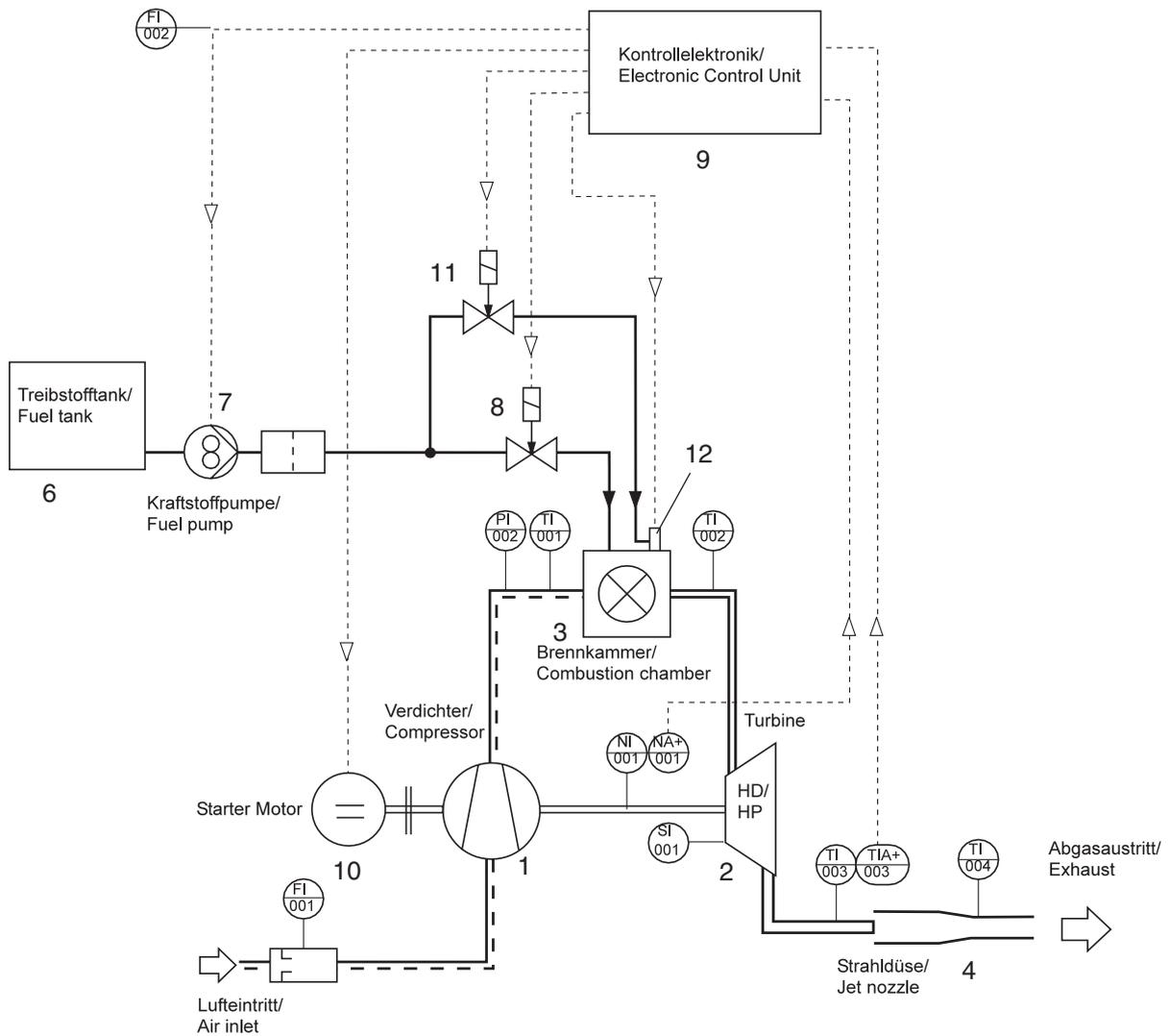
Fig. 2.1 Prozessdiagram Gasturbine
