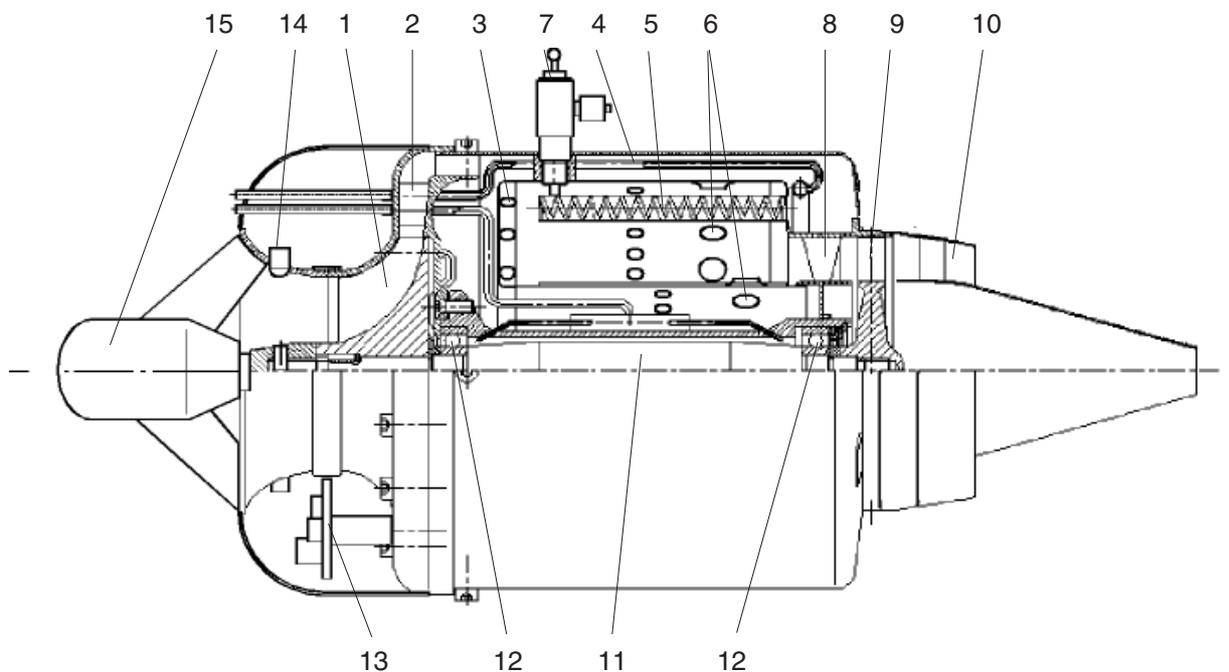
Fig. 2.3 Model-jetturbine
