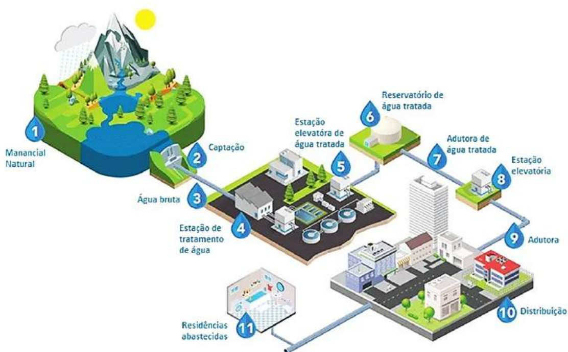
Figura 3.1 - Sistema de abastecimento de água de bombeamento direto.
