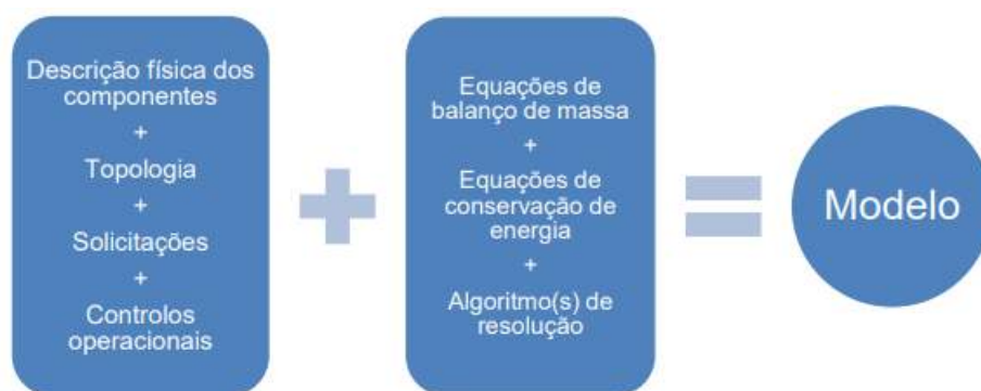
Figura 3.2 – Esquema de construção do modelo de um SDA.
