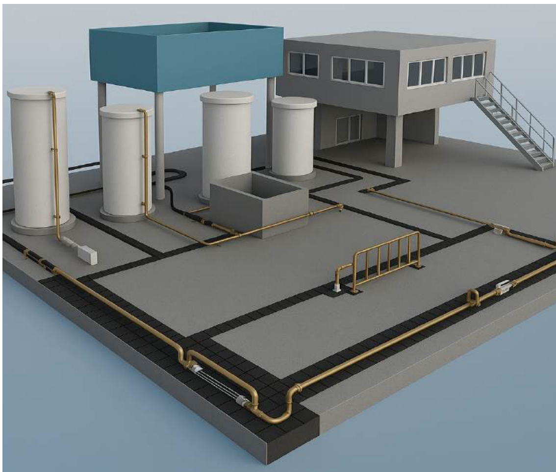
Figura 5.2 – Perspectiva do SPDA no Blender®.
