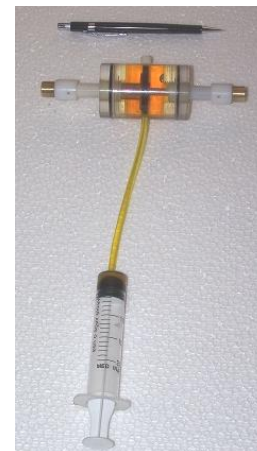
Fig. 3 – Estrutura usada para geração de DP preenchida com óleo.
