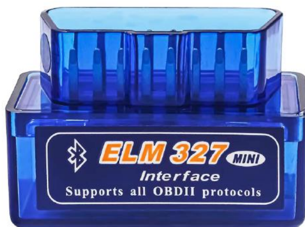
Figura 10 – Dispositivo ELM327 utilizado na coleta de dados (Elm Electronics Inc., 2017).
