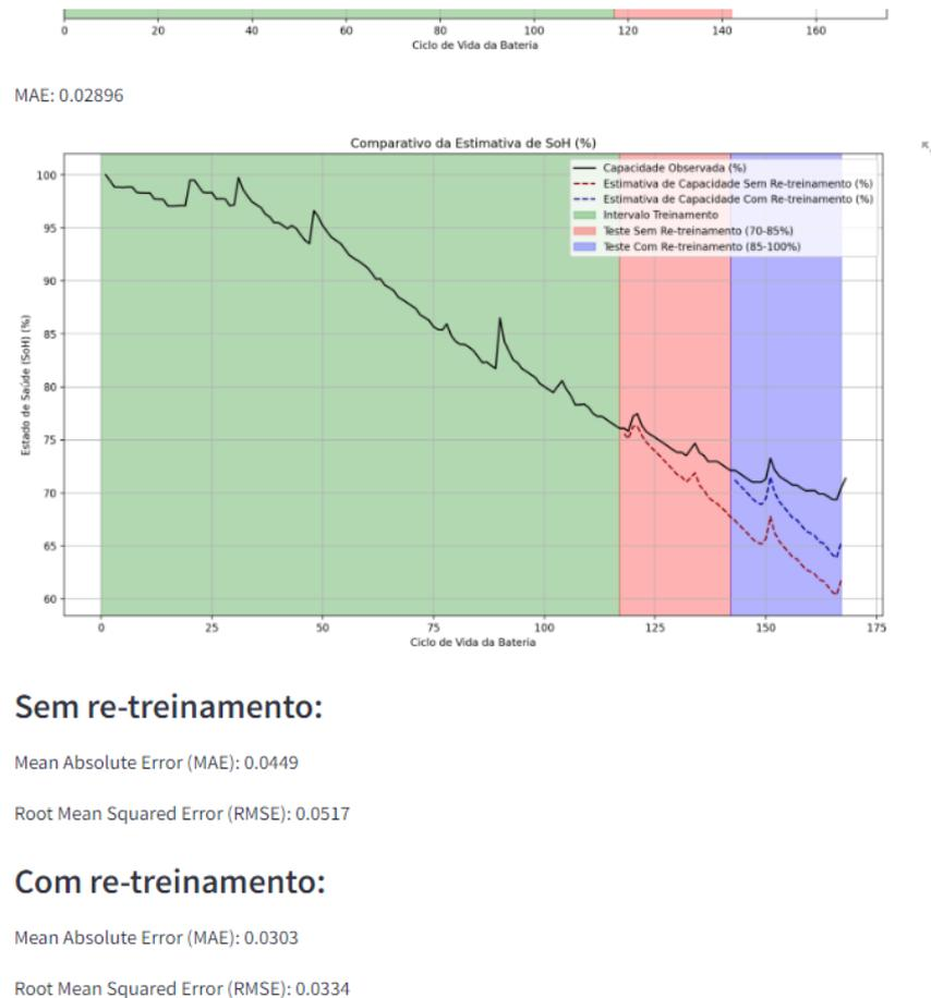
Figura 16 – Interface do Azure Web App apresentando os resultados de predição do SoH com e sem retreinamento.
