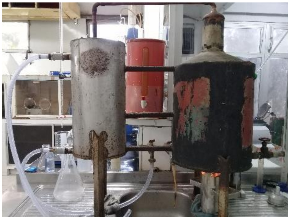
Figura 17: Destilação em alambique.
