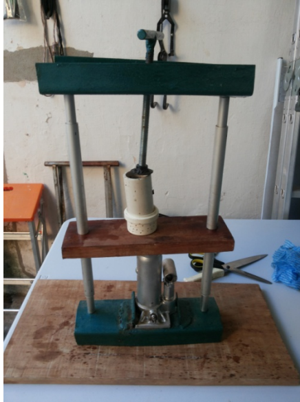
Figura 12 - Prensa de fabricação própria utilizada na produção dos briquetes.
