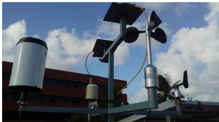
Figura 61. Piranômetro, sensor fotovoltaico, anemômetro, biruta, sensor de temperatura e humidade e pluviômetro, de uma estação meteorológica montada no CEAR/UFPB, João Pessoa - PB. Fonte: Guillermo Andrés Rodríguez Cantor. Acervo pessoal.
