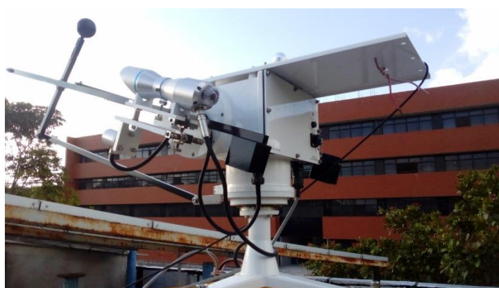
Figura 60. Suntracker EKO®, de uma estação meteorológica montada no CEAR/UEPB, João Pessoa - PB. Fonte: Guillermo Andrés Rodríguez Cantor. Acervo pessoal.
