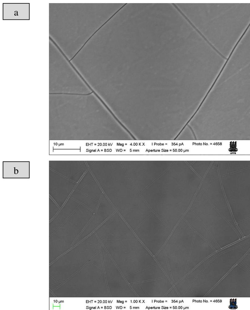
**Figura 39.** Microscopia eletrônica de varredura para as amostras com tratamento EP (eletropolimento) e tempo de deposição de 1 min. Magnificações: a) 4000x; b) 1000x.
