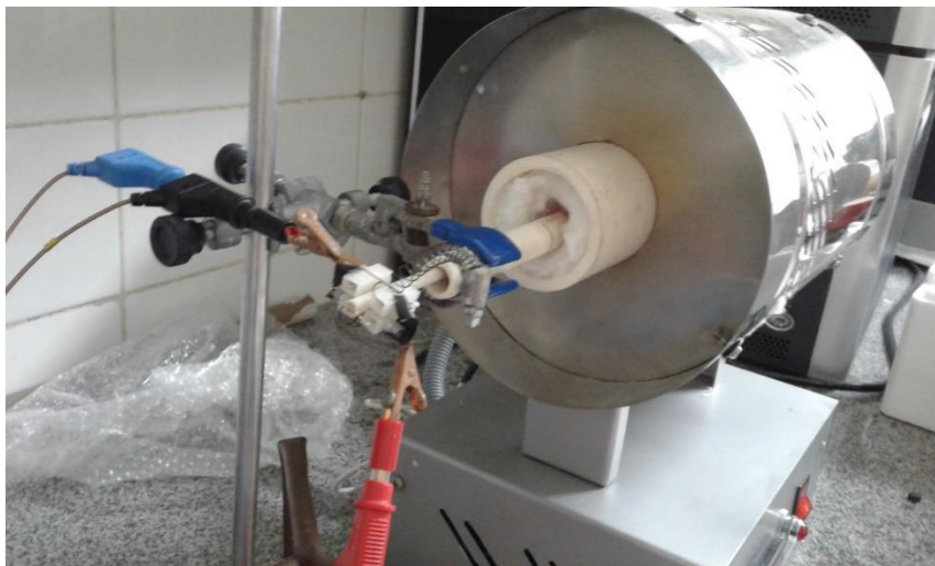
Figura 17. Detalhamento da ligação entre o porta-amostra e a unidade AUTOLAB.
