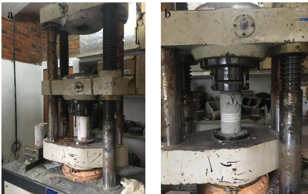
Figura 14. Ensaio de resistência mecânica MAA (a); Ensaio de resistência mecânica CP (b).
