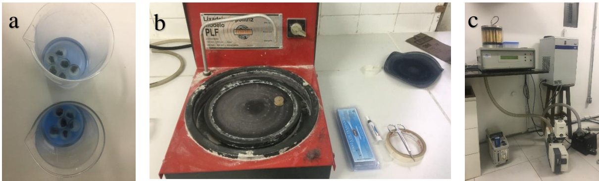
Figura 13. Amostras imersas em álcool isopropílico para o banho de ultrassom (a); Máquina de polimento com pasta diamantada (b) Processo de metalização das amostras (c).
