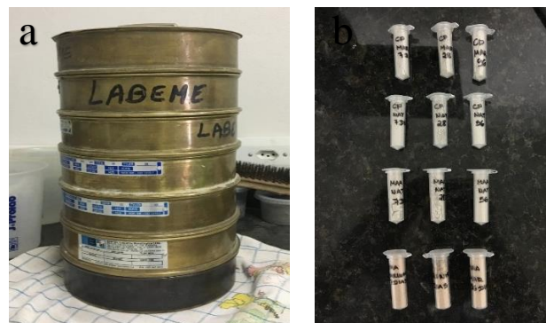
Figura 11. Peneiras utilizadas na preparação das amostras (a); Eppendorfs finalizados (b).
