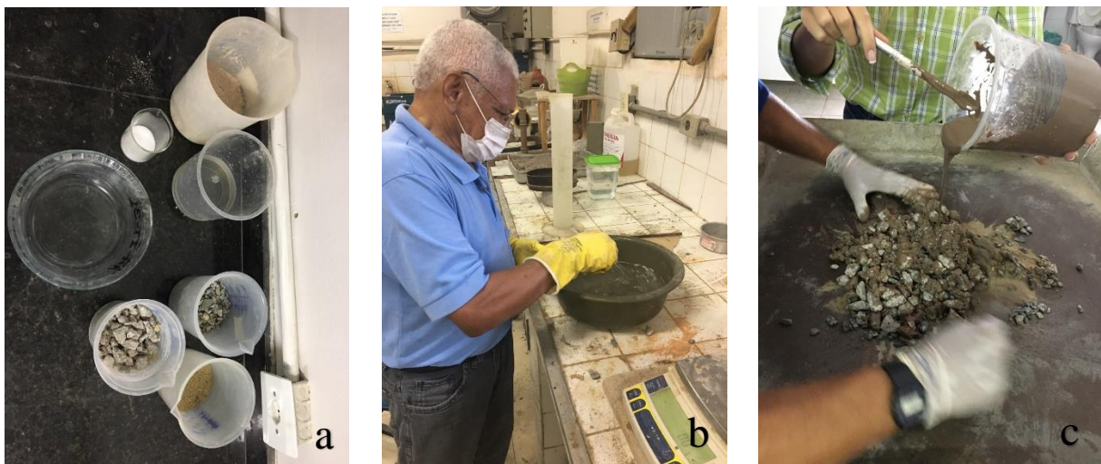
Figura 7. Separação e pesagem dos precursores para a pasta geopolimérica (a); mistura do NaOH com água ocasionando uma reação exotérmica (b) mistura da pasta geopolimérica com os agregados (c).
