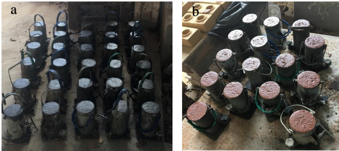
Figura 9. Corpos de prova de concreto à base de cimento portland (a); Corpos de prova à base de MAA (b).
