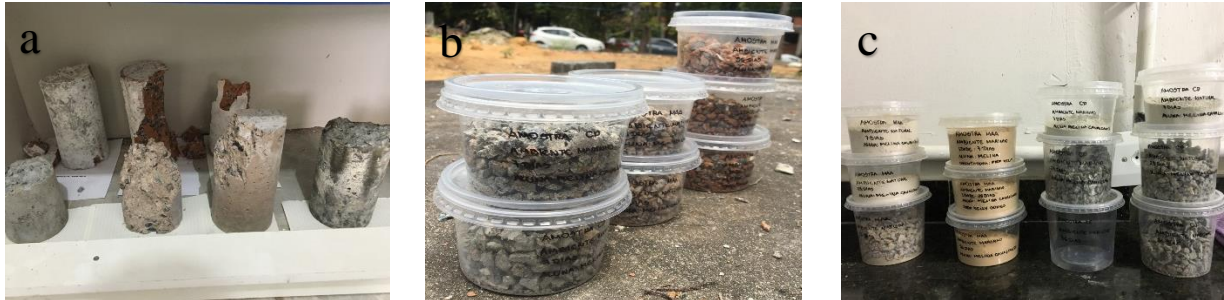
Figura 10. Corpos de prova rompidos (a); Amostras fragmentadas manualmente (b); Parte das amostras já maceradas após a moagem no moinho de bolas (c).
