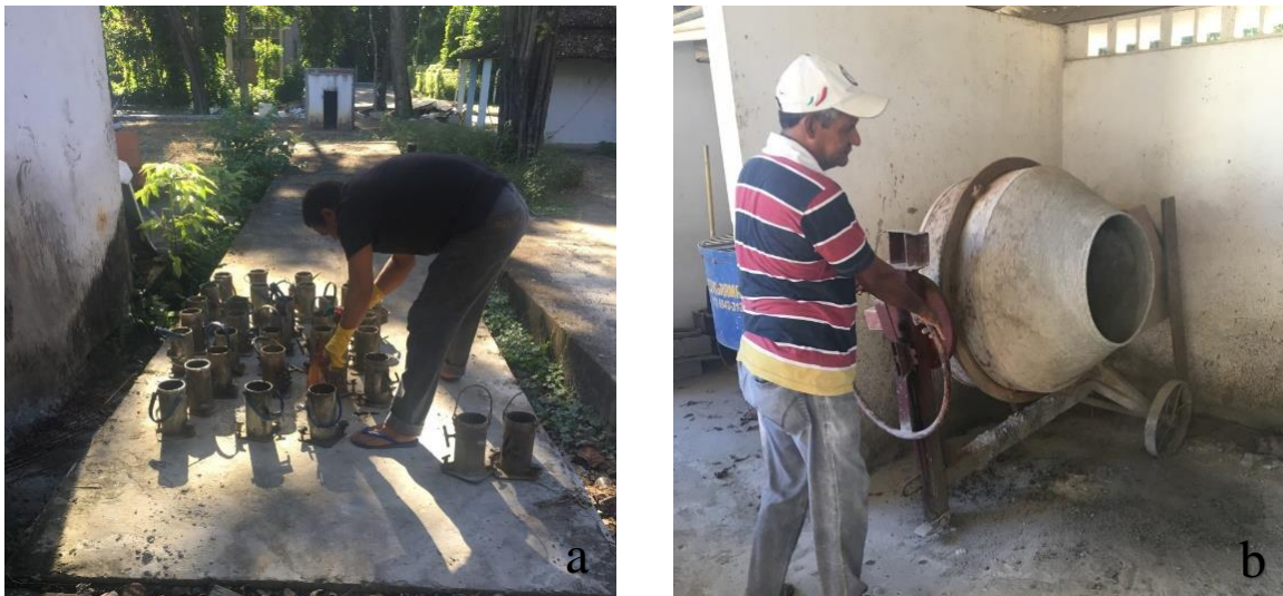
Figura 6. Preparação dos moldes untados com óleo mineral (a); mistura dos agregados secos e do cimento na betoneira (b).
