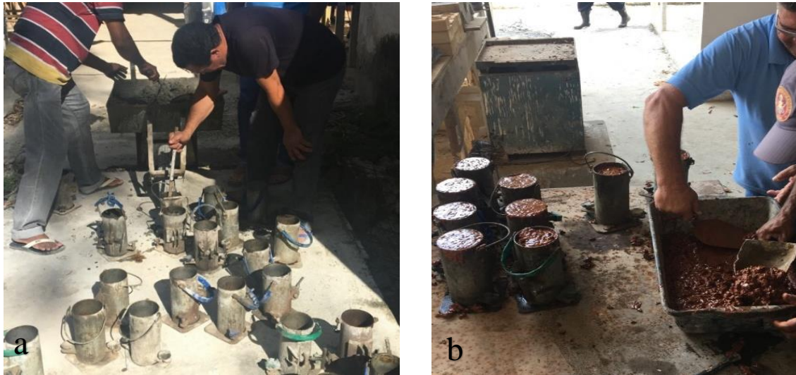
Figura 8. Moldagem dos corpos de prova à base de cimento portland (a) Moldagem dos corpos de prova à base de MAA (b).
