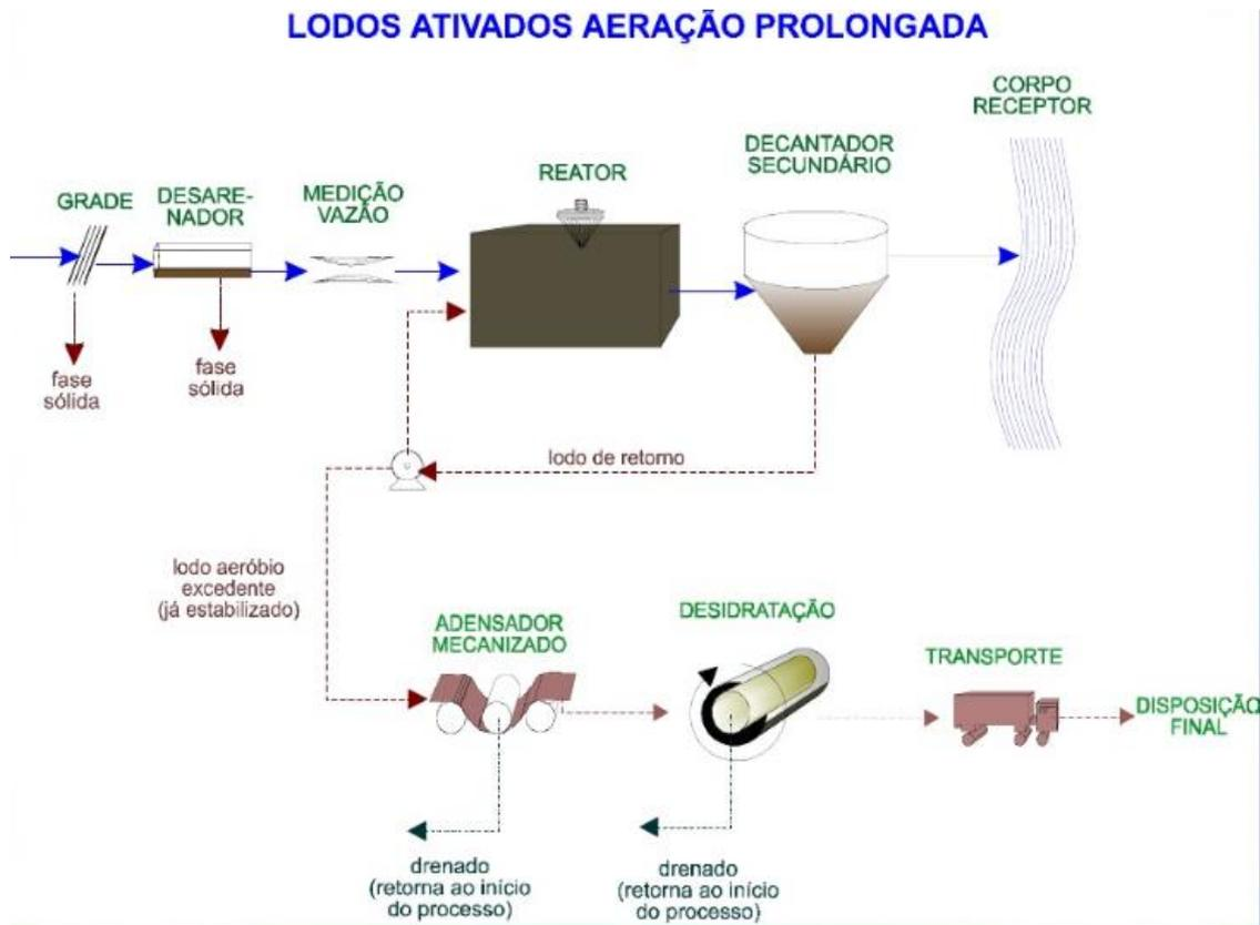
Figura 1.1 Sistema simplificado de uma ETE baseada no sistema de lodos ativados de aeração prolongada.
