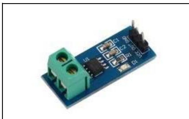
Figura 35. Sensor de corrente, tipo Hall, modelo ACS712 (até 5 A). Fonte: autoria própria.
