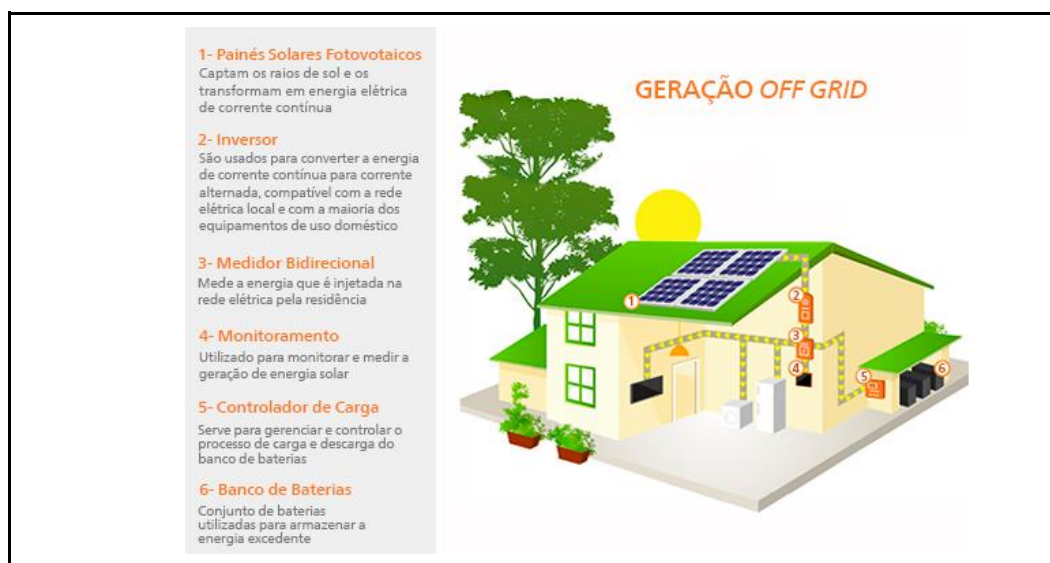
Figura 7. Modelo de sistema de geração distribuída de energia solar fotovoltaica off-grid . Fonte: adaptada de Strom Brasil, 2018.
