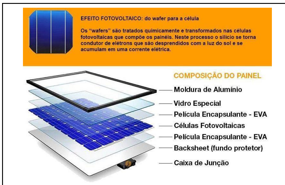
Figura 8 . Esquema de um módulo fotovoltaico (genérico). Fonte: adaptada de Strom Brasil, 2018.
