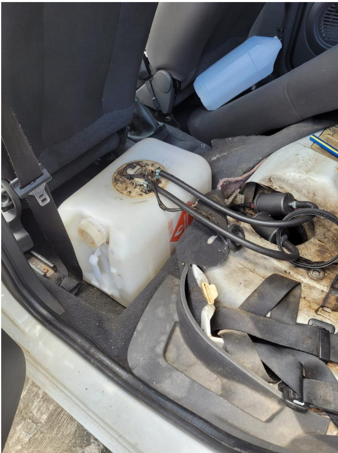
Figura 16 - Modificação do tanque de combustíveis.
