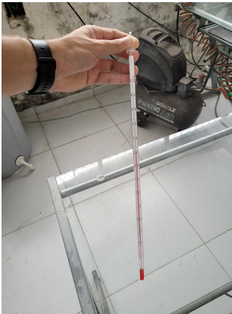
Figura 8 - Termômetro para massa específica de álcool etílico e suas misturas.
