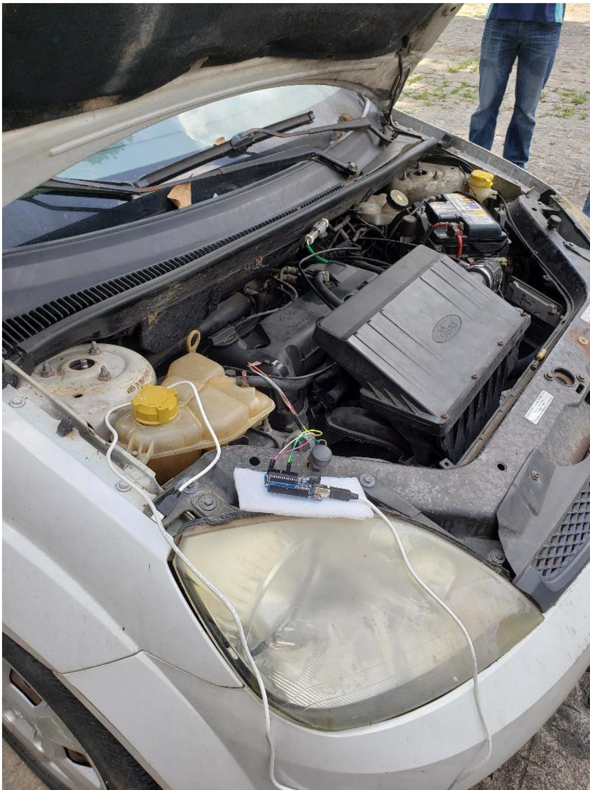
Figura 19 - Posicionamento do equipamento de aquisição do sinal da vibração do motor.
