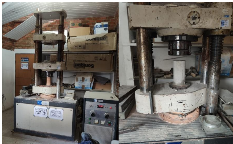
Figura 6: Ensaio de compressão axial para o MAA (a) e para o concreto de cimento Portland(b)
