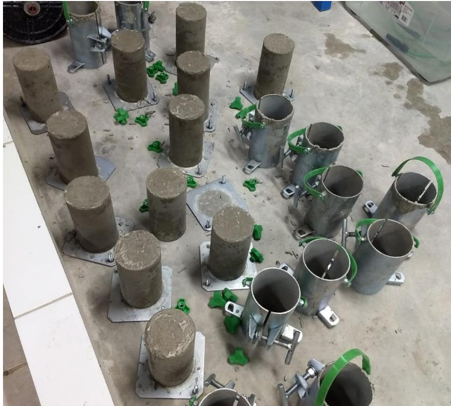
Figura 2: Moldagem dos corpos de prova – Concreto de cimento Portland.
