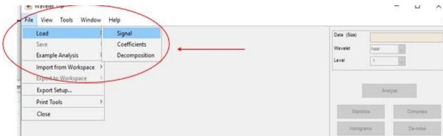
Depois do carregamento da variável, colocamos a família ao qual foi comentada na seção 2.4.8 e analisamos os coeficientes de aproximação e de detalhe (Figura 48). E, por fim, exportamos esses coeficientes para comparar com o sinal original (Figura 49). Esse procedimento é realizado para as distâncias de 0.25 m, quanto para 0.5 m e 1 m.
