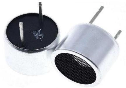
*Figura 3 - Sensor Ultrassônico Um 18*
